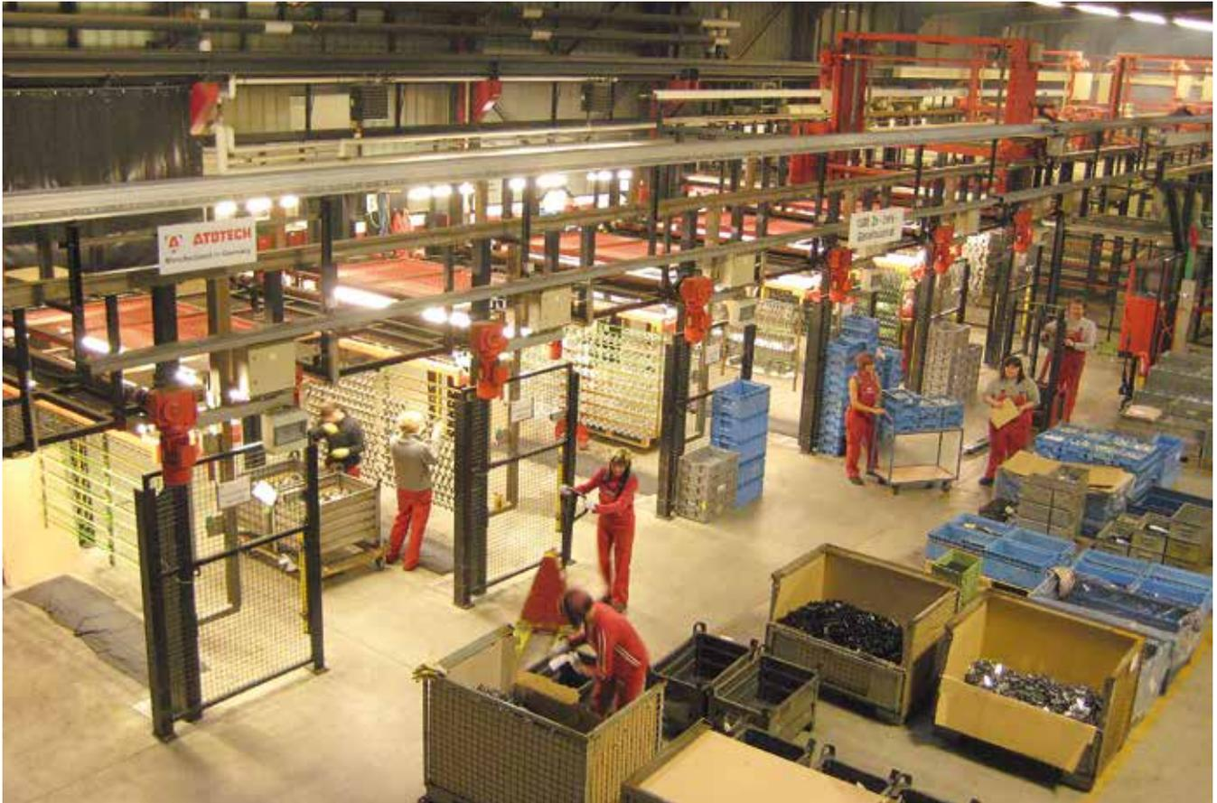
Die Produktion am Zink/Zinklegierungsgestellautomaten läuft bereits Ende 2006 im Drei-Schicht-System.
