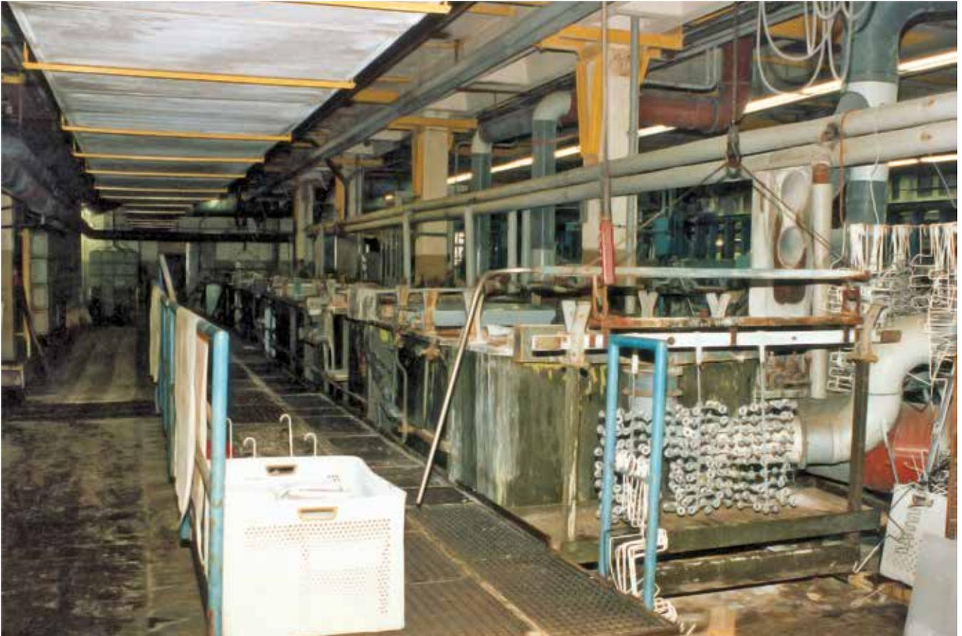
Anlage mit alter Produktionstechnik in Zwickau, hier die Phosphatier-Brünieranlage
