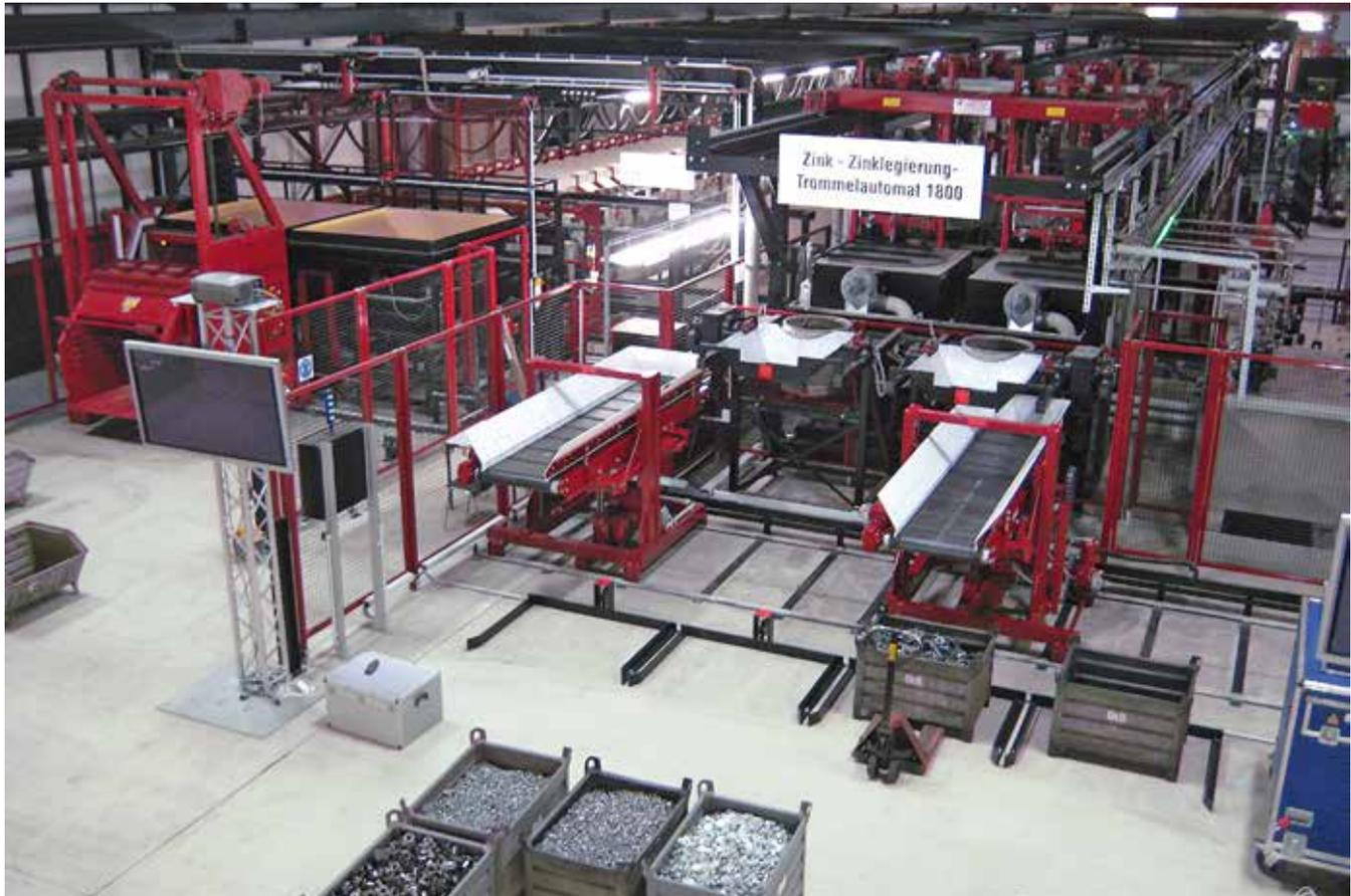
Der moderne Doppeltrommelautomat, mit bis zu 90 Tonnen Tageskapazität, geht von Beginn an in den Drei-Schicht-Betrieb.
