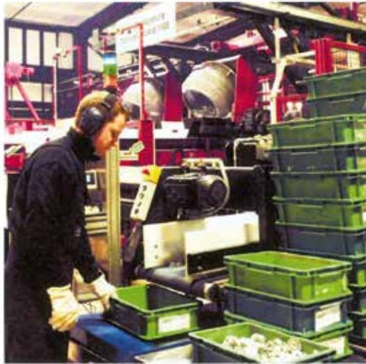
Produktionshelfer Jiri Polich bestückt Kästen mit galvanisierten Metallteilen. Beschichtet wurden sie in einem Trommelautomat (im Hintergrund), dem die größte neue Anlage hinzugefügt wird.
